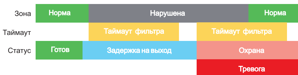
Рисунок 15. Нарушение зоны в момент постановки на охрану.
